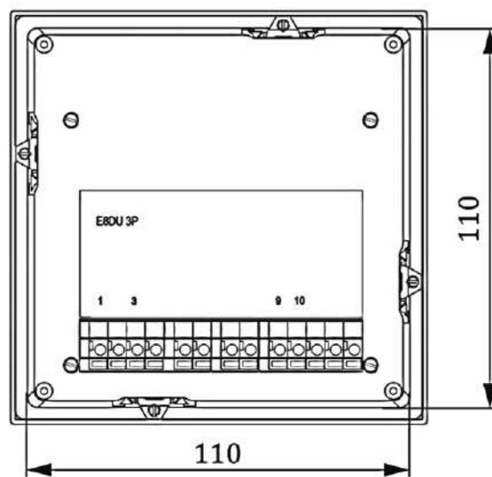
Рисунок А.4 – Габаритные и установочные размеры внешнего трехстрочного показывающего устройства E8DU 3P
